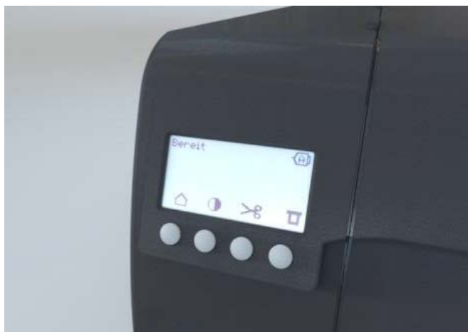
Дисплей (128x64 пикселей) и кнопки принтера XLP 504
